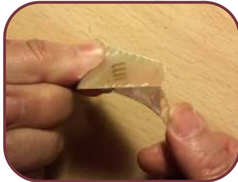
Fig. 16: Doblando el trozo de DVD se separa la parte plateada de la que se usa de red.
