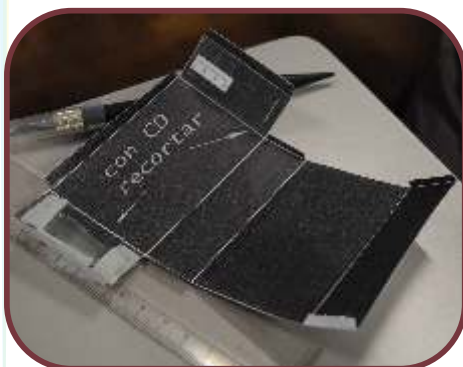
Fig. 11: Recortar y armar el espectroscopio, dejando la parte negra por dentro.
