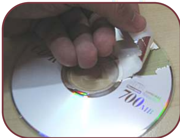
Fig. 10: Retirando la capa metálica del CD con cinta adhesiva.
